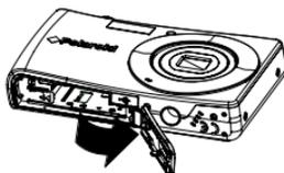
3. Insérez la batterie dans le compartiment avec la borne dirigée vers l'intérieur de l'appareil photo et l'orientation correcte comme illustré.
